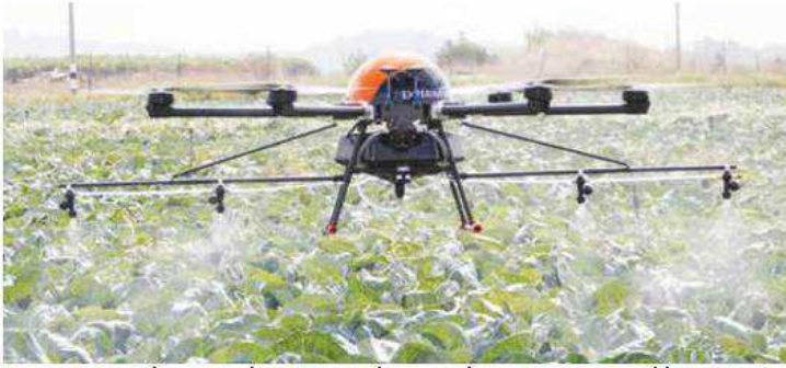
רחפן ברקת. מסוגל לשהות באוויר עד 45 דקות, לשאת עד 15 ליטר חומרי ריסוס ולכסות שטח של כ-60 דונם בשעה
